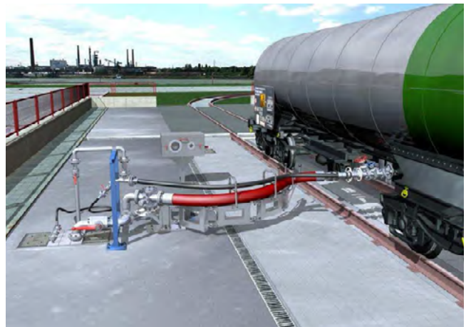
Abbildung 13a: Verlegen von Schlauch- leitungen – Schlauchgelenkarm
